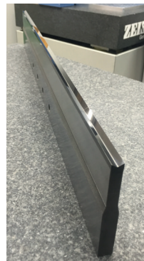
Nyslipad hårdmetallskena. Vi slipar längder upp till 3 meter.
